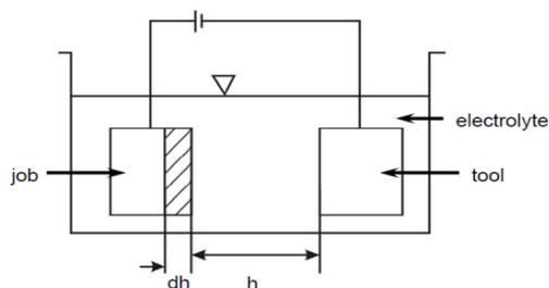
شکل ۱. شماتیک ماشینکاری بدون تماس قطعه با ابزار. (قلم ۱۳ بی زر نازک)
